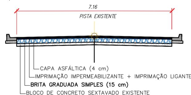
**DETALHE DA SEÇÃO DE RECAPEAMENTO ASFÁLTICO**
