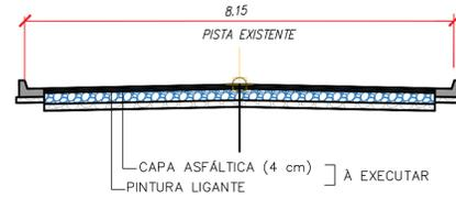
DETALHE DA SEÇÃO DE RECAPEAMENTO ASFÁLTICO
