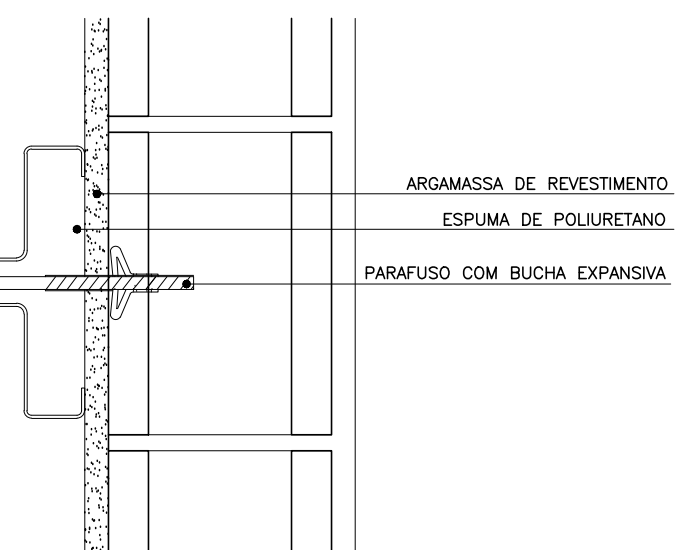
DETALHE FIXAÇÃO BATENTE METÁLICO ESCALA 1:5
