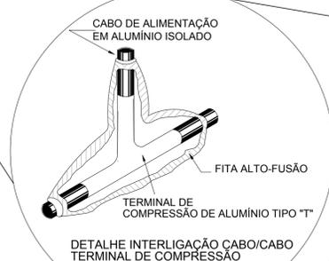
DETALHE INTERLIGAÇÃO CABO/CABO TERMINAL DE COMPRESSÃO
