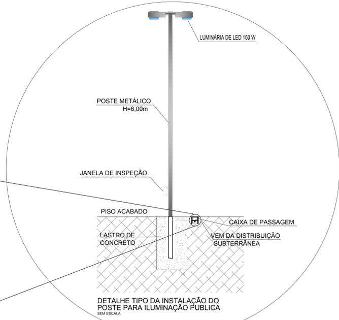
DETALHE TIPO DA INSTALAÇÃO DO POSTE PARA ILUMINAÇÃO PÚBLICA
